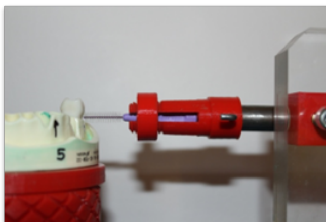
Figure 20 : Système de serrage utilisé pour les brosses interdentaires (Document personnel).
